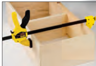
Ściskanie klejonego elementu
