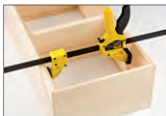
Rozpieranie klejonego elementu
